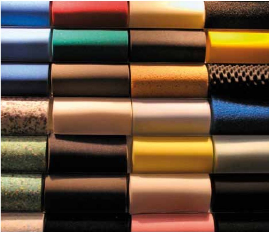
Kuva 6, yllä: Polyuretaani voi olla joko kertamuovi tai kestopuovi. Se voi myös olla jäykkää tai hyvin joustavaa, kuten vaahtomuovi.
